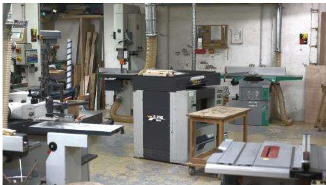
Atelier équipé de scies à ruban, dégauchisseuses, raboteuses, mortaiseuse, toupie, scie à format...
